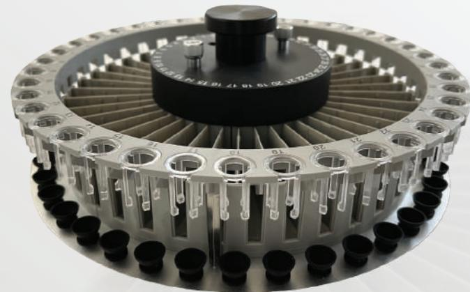
قابلیت استفاده از کاپ و لوله های آزمایش استاندارد
